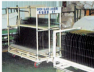
Carros portátiles para puerta del vidrio MOVING CART FOR DOOR GLASS
