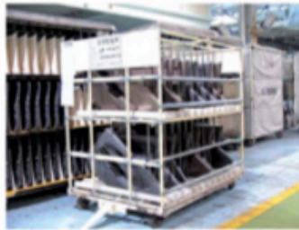
Carro del embarque portátil para sacar las puertas TRIM MOVING CART FOR DOOR TRIM PICKING
